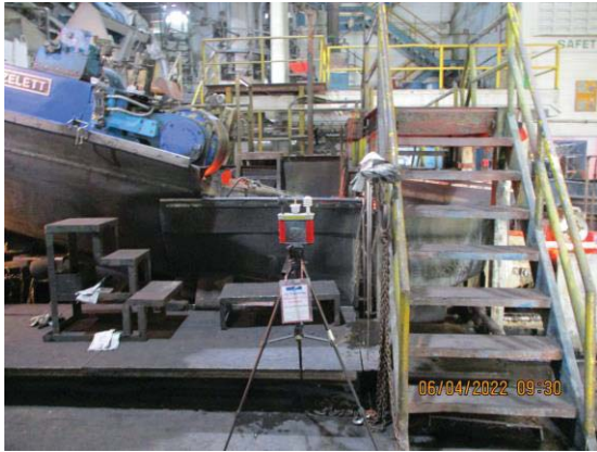
รูปที่ 4-47 แสดงการตรวจวัดระดับความร้อนในการทำงาน หน้าเครื่องหล่อ (คุณครรชิต แก้วชม) ตรวจวัดในวันที่ 6 เมษายน 2565
