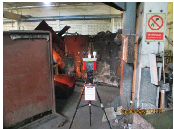
รูปที่ 4-48 แสดงการตรวจวัดระดับความร้อนในการทำงาน รางส่งน้ำทองแดง 1 (คุณเกษม หอมกลิ่นคล้าย) ตรวจวัดในวันที่ 6 เมษายน 2565
