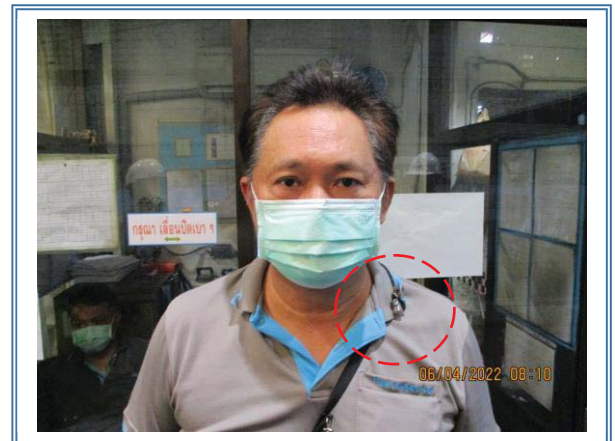
รูปที่ 4-38 แสดงการตรวจวัดปริมาณเสียงสะสม บริเวณเครื่องรีด (คุณรัชชัย ต่อเทียนชัย) ตรวจวัดในวันที่ 6 เมษายน 2565
